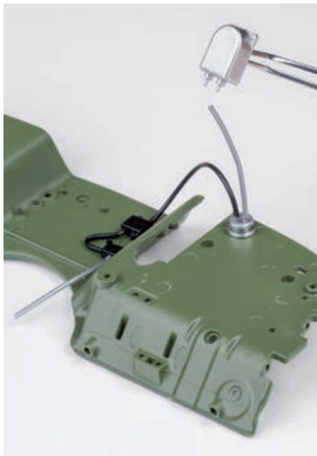
Шаг 10. Закрепите свободные концы левого и правого проводов фильтра на левом и правом крепежных штырях фильтра радиопомех. В дальнейшем фильтр будет закреплён на перегородке моторного отсека выше рулевой колонки.
