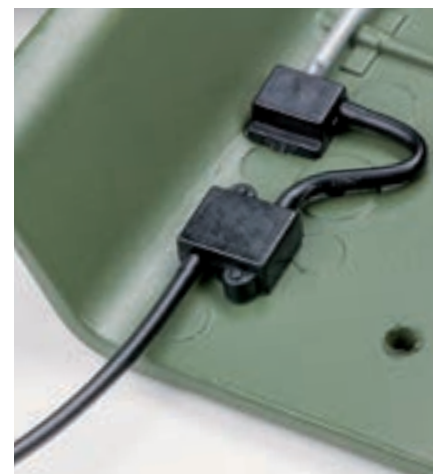
Шаг 6. На верхний крепежный штырь блока предохранителей поместите верхний провод блока предохранителей длиной 60 мм.
