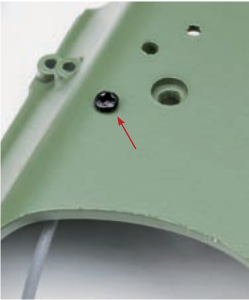
Шаг 4. Над корпусом реле стартера установите на перегородку моторного отсека блок предохранителей. Закрепите блок при помощи винта 1,7×4 (AP).
