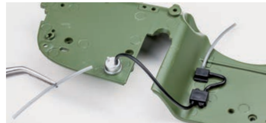
Шаг 9. Установите левый провод фильтра длиной 40 мм на свободном левом крепежном штыре вариатора.
