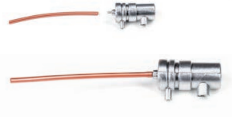
Шаг 11. Зафиксируйте провод к катушке зажигания на штыре, расположенном в торцевой части корпуса катушки зажигания.
