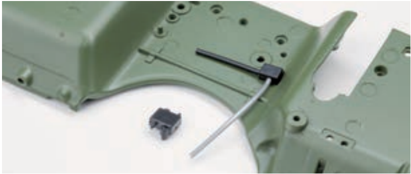
Шаг 4. Над корпусом реле стартера установите на перегородку моторного отсека блок предохранителей. Закрепите блок при помощи винта 1,7×4 (AP).
