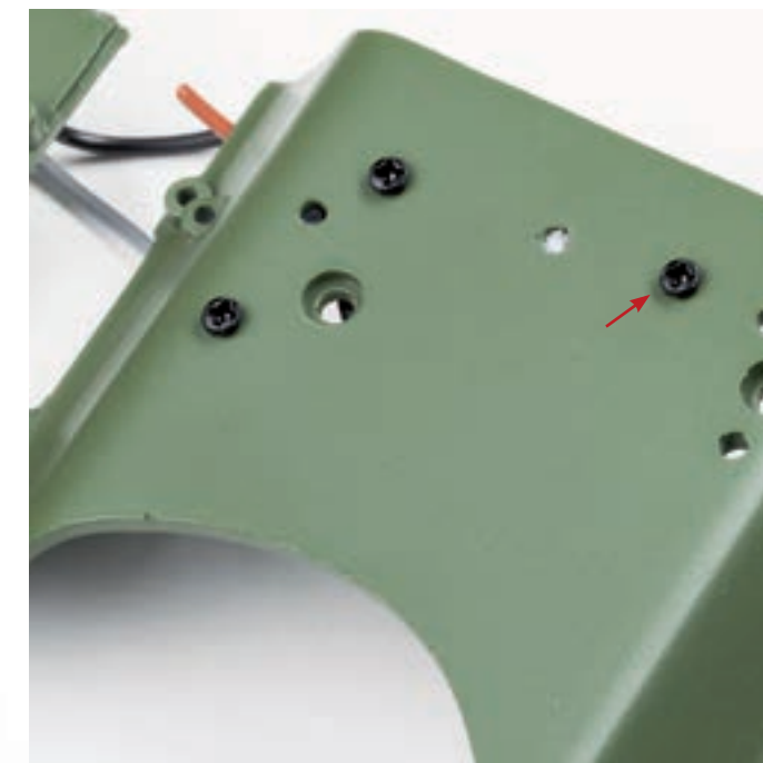
Шаг 12. Установите катушку зажигания в центральной части перегородки моторного отсека. Обратите внимание: высоковольтный провод должен быть направлен в сторону блока предохранителей. Для фиксации катушки используйте винт 1,7×4 (AP).
