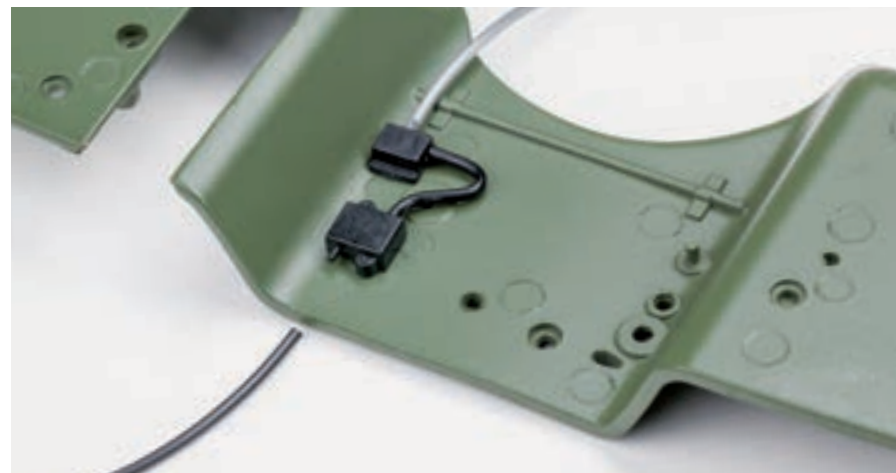
Шаг 6. На верхний крепежный штырь блока предохранителей поместите верхний провод блока предохранителей длиной 60 мм.
