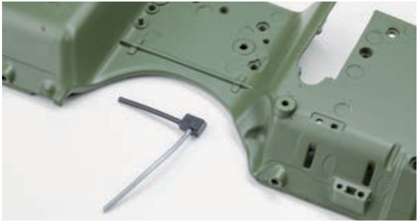
Шаг 3. Разместите реле стартера в средней части перегородки моторного отсека со стороны двигателя и закрепите его с обратной стороны перегородки винтом 1,7×4 (AP). Реле должно быть закреплено в левой части углубления перегородки над имитацией тяги привода педали управления дросселем карбюратора.
