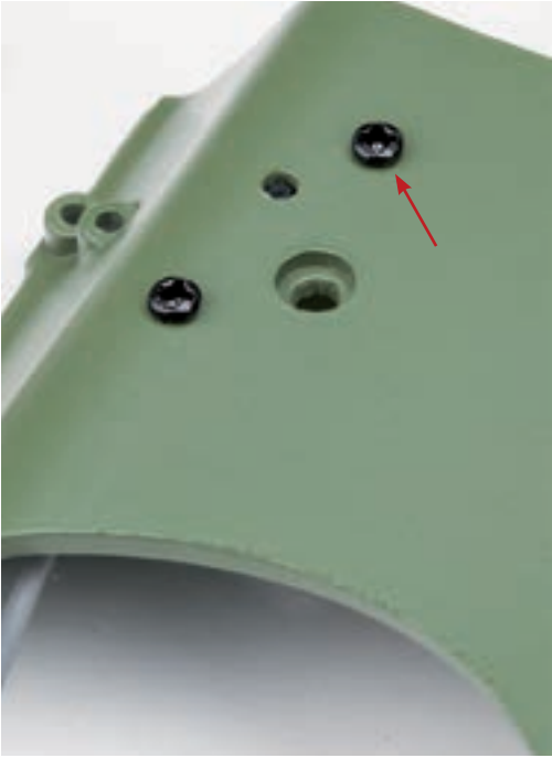
Шаг 4. Над корпусом реле стартера установите на перегородку моторного отсека блок предохранителей. Закрепите блок при помощи винта 1,7×4 (AP).
