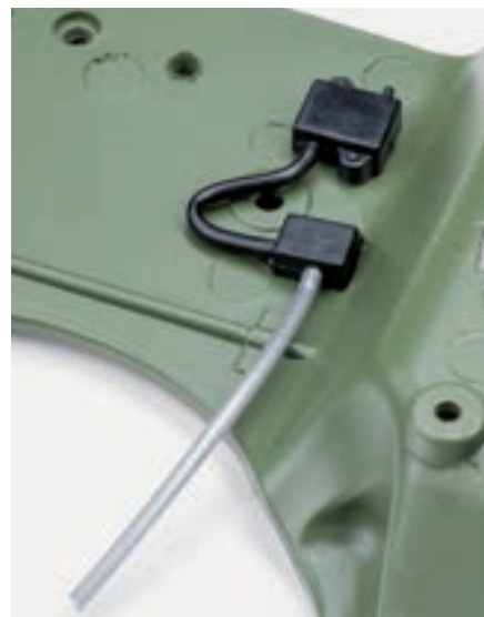
Шаг 5. Закрепите боковой провод от реле стартера на нижнем крепежном штыре блока предохранителей.
