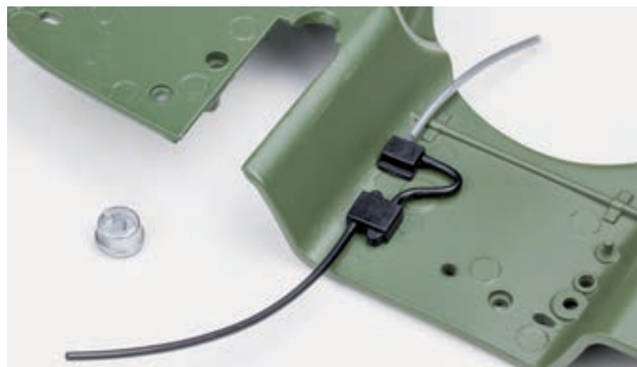
Шаг 7. В верхней части перегородки, рядом с вырезом под рулевую колонку, установите и закрепите вариатор. Для фиксации детали используйте винт 1,5×4 (ВР).
